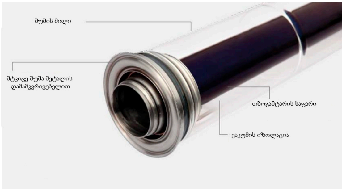
ნახ. 44. ღარისებური მზის ელ.სადგურის თბოშემკრები ელემენტი
