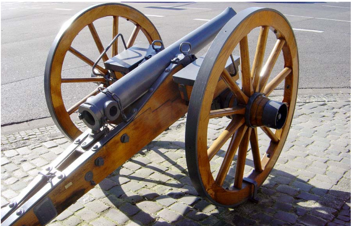
კრუპის პირველი მსხვილსერიანი სახაზინო ნაწილიდან დასატენი ფოლადისლულიანი ქვემეხი – Feldkanone C/61. პრუსიის არმიის შეიარაღებაში მიღებულ იქნა 1861 წელს
