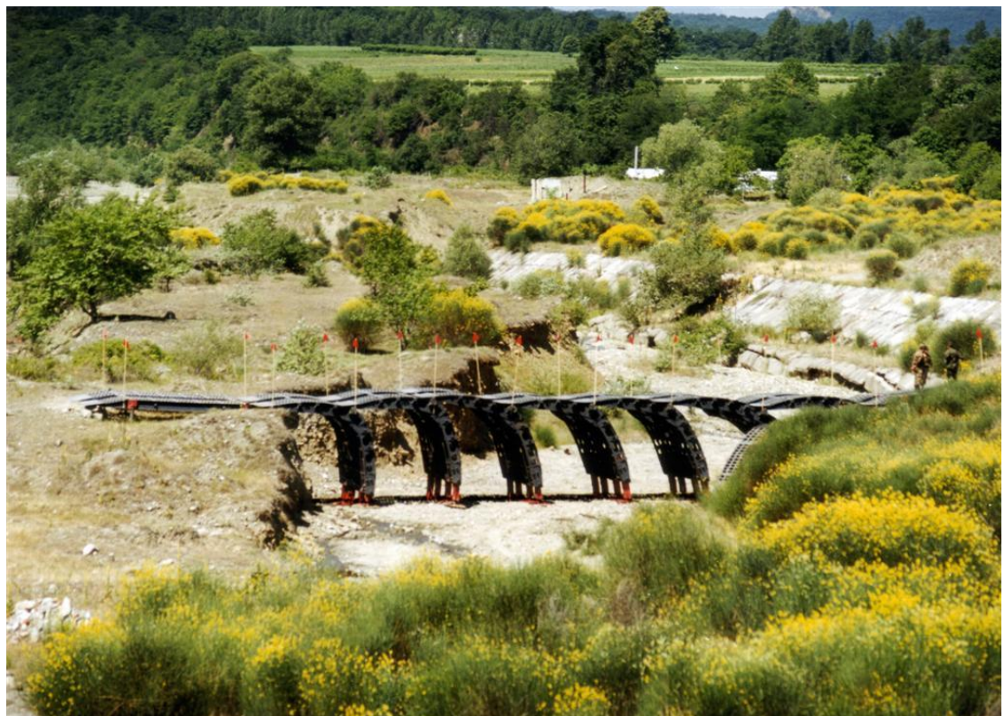
ნახ. 13 – საშტატო საბრძოლო ტექნიკის–ხიდი KM-02T საველე წვრთნებსა და გამოცდებზე
