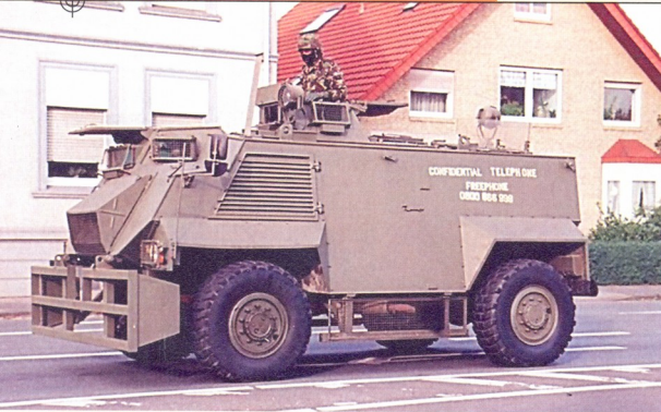
AT-105 Saxon: მასა — 11,6 ტ, ეკიპაჟი — 2 კაცი, დენანტი — 8 კაცი, დიზელის ძრავა 160-ცხ.ძალიანი, სიჩქარე — 96 კმ/სთ-ში, სვლის მარაგი — 510 კმ, შეიარაღება — 7,62 მმ-იანი, ან 12,7 მმ-იანი ტყვიამფრქვევი, ან საეცსაშუალებები
