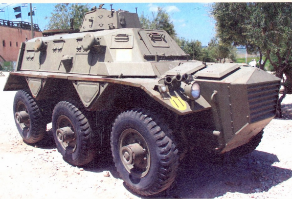
FV603 Saracen: მასა — 10,17 ტ, ეკიპაჟი — 2 კაცი, ღესანტი — 9-10 კაცი, ჯავშანი — 8-16 მმ, კარბურატორიანი ძრავა 160-ცხ.ძალიანი, სიჩქარე — 72 კმ/სთ-ში, სელის მარაგი — 400 კმ, შეიარაღება — 7,62 მმ-იანი ტყვიამფრქვევი
