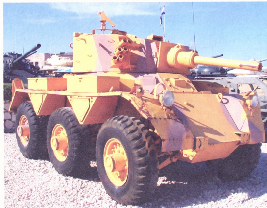
FV601 Saladin: მასა — 11,7 ტ, ეკიპაჟი — 3 კაცი, ჯავშანი — 8-32 მმ, კარბურატორიანი ძრავა 160-ცხ. ძალიანი, სიჩქარე — 72 კმ/სთ-ში, სელის მარაგი — 400 კმ, შეიარაღება — 76 მმ-იანი ქვემეხი და ორი 7,62 მმ-იანი ტყვიამფრქვევი
