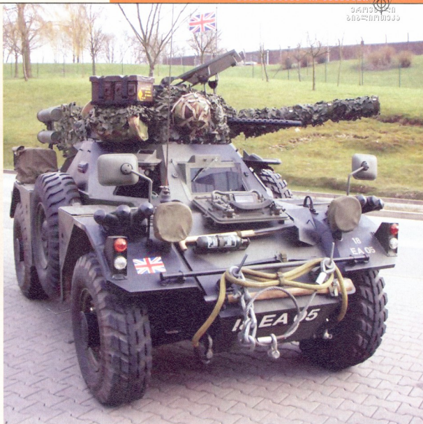
FV701 Ferret MkI: სრული მასა — 6 ტ, ეკიპაჟი — 3 კაცი, კარბურატორიანი ძრავა 116-ც.ბალიანი, სიჩქარე — 93 კმ/თ-ში, სელის მარაგი — 300 კმ, შეიარაღება — 7,62 მმ-იანი ტყვიამფრეკვეი
