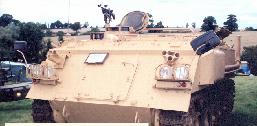
FV432 Trojan: მასა — 15,3 ტ, ეკიპაჟი — 2 კაცი, დენსანტი — 10 კაცი, ჯეჟმანი მაქსიმალური — 16 მმ, დიზელის ძრავა 240-ცხ. ძალიანი, შეიარაღება — 7,62 მმ-იანი ტყვიამფრეკვეითი
