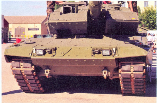
საბჭოურებისგან განსხვავებით, დასავლურ ტანკებზე რუხინისბუნიკებიან მუხლუხებს ქარხანაშივე აყენებენ. ზედა ფოტო — ბრიტანული Challenger. ქვედა ფოტოზე — გერმანული Leopard 2
