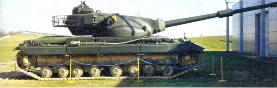
Conqueror Mk2: მასა — 66 ტ, კეიბაჟი — 4 კაცი, ჯავშანი — 200 მმ, კარბურატორიანი ძრავა 810-ცხ. ძალიანი, სიჩქარე — 34 კმ/სთ-ში, სულის მარაგი — 65 კმ, შეიარაღება — 120 მმ-იანი ქვემეტი, ორი 7,62 მმ-იანი და ერთი 12,7 მმ-იანი ტყვიამფრქვევი
