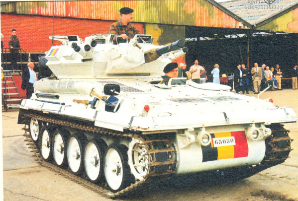
Scorpion: მასა — 8,0 ტ, ვეიპაჟი — 3 კაცი, სიქარე — 80 კმ/სთ-ში, სელის მარაგი — 640 კმ, შეიარაღება — 76 მმ-იანი ქვეტები და ორი 7,62 მმ-იანი ტევიამფრქვევი
