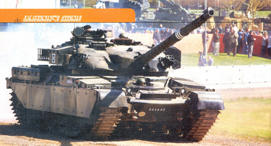
Chieftain Mk3: სრული მასა — 54 ტ, კეაბაი — 4 კაცი, დიზელის ძრავა 730-ცხ.ძალადანი, სიჩქარე — 41 კმ/სთ-ში, სელის მარაგი — 500 კმ, შეიარაღება — 120 მმ-იანი ქვეშები, ორი 7,62 მმ-იანი და ერთი 12,7 მმ-იანი ტყვიანობა
