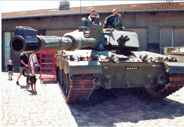
საბჭოურებისგან განსხვავებით, დასავლურ ტანკებზე რუხინისბუნიკებიან მუხლუხებს ქარხანაშივე აყენებენ. ზედა ფოტო — ბრიტანული Challenger. ქვედა ფოტოზე — გერმანული Leopard 2
