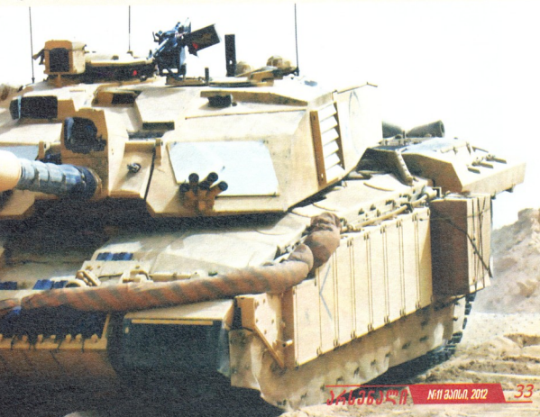
Challenger 2: მასა — 62,5 ტ, ვეიპაჟი — 4 კაცი, დიზელის ძრავა 1200-ც.ძალიანი, სიქარე — 40-56 კმ/სთ-ში, სელის მარაგი — 250-400 კმ, შეიარაღება — 120 მმ-იანი ქვეტები და ორი 7,62 მმ-იანი ტევიამფრქვევი
