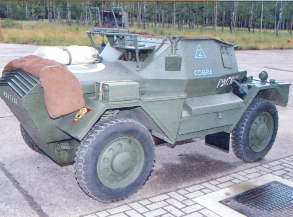
Daimler Dingo MkII: მასა — 3,0 ტ, ეკიპაჟი — 2 კაცი, ჯავშანი — 10-30 მმ, კარბურატორიანი ძრავა 55-ცხ.ძალიანი, სიჩქარე — 88 კმ/სთ-ში, სელის მარაგი — 322 კმ, შეიარაღება — 7,71 მმ-იანი ტყვიამფრექვეი
