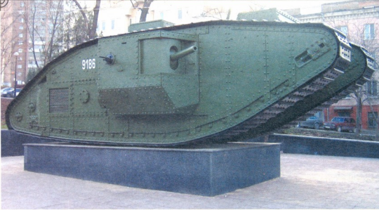
MKV „მამალი“: მასა — 29,47 ტ, ეკიპაჟი — 8 კაცი, ჯვრშიანი — 6-14 მმ, კარბურატორიანი ძრავა 150-ცხ. ძალიანი, სიჩქარე — 7,5 კმ/სთ-ში, სელის მარაგი — 72 კმ, შეიარაღება — ორი 57 მმ-იანი ქვემეტი და ოთხი 7,7 მმ-იანი ტყვიამურქვევი
