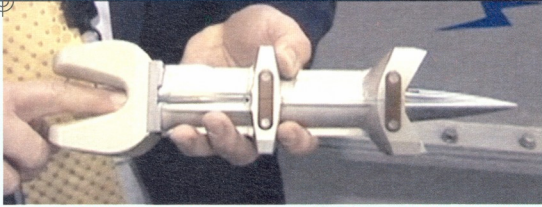
„რელსტონის“ პროტოტიპის ჭურვი მხოლოდ რამდენიმე კოლოგრამს იწონის, მაგრამ პიპერბგერითი სიჩქარის წყალობით სამიზნეს კინეტიკური ენერჯით ანადგურებს
