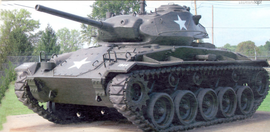
M24 General Chaffee: მასა — 17,6 ტ, ეკიპაჟი — 4-5 კაცი, ჯგუფი — 12,7-38,1 მმ, კარბურატორიანი ძრავა — 220-ცხ. ძალის, სიჩქარე — 58 კმ/სთ-ში, სვლის მარაგი — 160 კმ, შეიარაღება — 75 მმ-იანი ქვემეტი, 12,7 მმ-იანი და ორი 7,62 მმ-იანი ტყვიამფრექვეი
