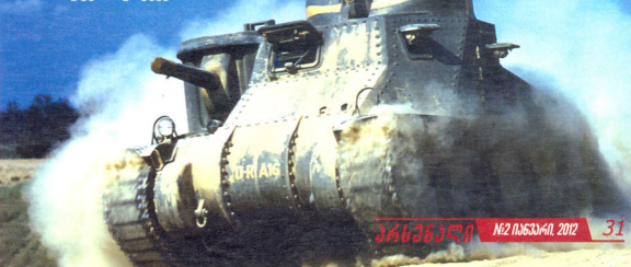
M3 General Lee: მასა — 27,92 ტ, ეკიპაჟი — 6-7 კაცი, ჯგუფი — 12,7-50 მმ, კარბურატორიანი ძრავა — 340-ცხ. ძალის, სიჩქარე — 40 კმ/სთ-ში, სვლის მარაგი — 230 კმ, შეიარაღება — 75 მმ-იანი და 37 მმ-იანი ქვემეტები, სამი 7,62 მმ-იანი ტყვიამფრექვეი
