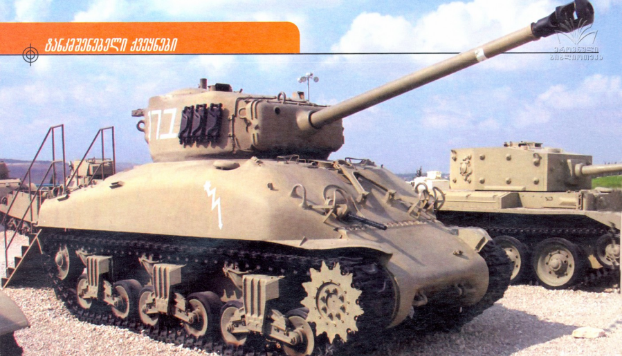
M4A1 General Sherman-ი: მასა — 30,37 ტ, კვაბაფი — 5 კაცი, ჯგუფი — 12,7-76,2 მმ, კარბურატორიანი ძრავა — 350-ცხ.ძალიანი, სიჩქარე — 38 კმ/სთ-ში, სვლის მარაგი — 192 კმ, შეიარაღება — 76 მმ-იანი ქვემუხი, ერთი 12,7 მმ-იანი და ორი 7,62 მმ-იანი ტყვიამფრეველი
