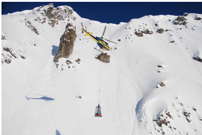
ნახ.34. ზვავშემკრებზე DAISYBELL სისტემით ზემოქმედება.
