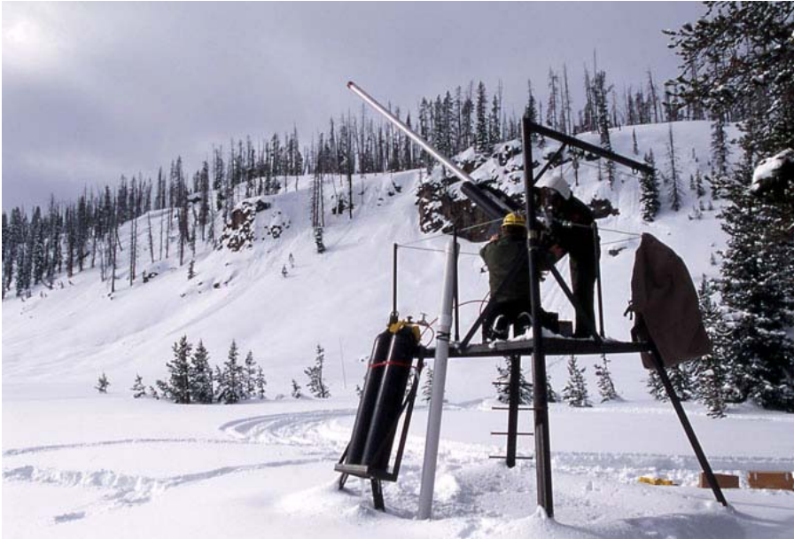
ნახ.33. პნევმატური ქვემეხი AVALAUNCHE .
