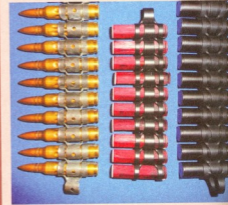
5.5 წმ-იანი კალიბრის საბრძოლო მასალები. (მარცხნიდან მარჯვნივ) სტანდარტული ვაზნა, ტელესკოპური ვაზნა პლასტმასის მასრით და ტელესკოპური უმასრო ვაზნა
