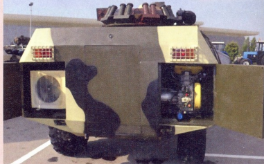
აზერბაიჯანელებმა BRDM-2-ს კონდიციონერი დაუყენეს და ასფალტზე ზეითის ლაქები შესრულებული სამუშაოების დაბალ ხარისხზე მიუთითებს
