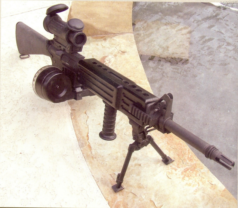
ჩხენი ღოსია: ამერიკული ხელის ტყვიამფრქვევი M16 A4 LSW 5,78 კვ-ს იწონის. მისი სიგრძე ერთ მეტრამდეა, ლულის სიგრძე კი 510 მმ-ს შეადგენს. მჭიდში 5,56 მმ კალიბრის 30 ცალი ვაზნა ჩადის, ხოლო Beta-C-ს ტიპის ორმაგდოლურიანი მჭიდის დაყენების შემთხვევაში ვაზნების მარაგი 100-მდე იზრდება. ხელის ტყვიამფრქვევიდან სროლის ტემპი 600-750 გასროლაა წუთში.
