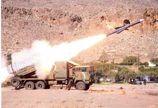
ბერძენი მოზრებულები აღმოჩნდნენ — სანაპირო დაცვისთვის, ჩამოყრებილი ხომალდებიდან მოხსნილი Exocet-ის გამშვები კონტეინერები, მანქანებზე დააყენეს
