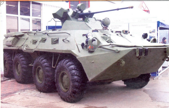
БТР-80А: მასა — 13,6 ტ, გეიპაუი — 3 კაცი, ღესანტი — 7 კაცი, ჯავშანი — 7-10 მმ, დიხელის ძრავა — 260 ცხ.ძალიანი, სიჩქარე — 80 კმ/სთ-ში, სვლის მარაგი — 200-600 კმ, შეიარაღება — 14,5 მმ-იანი და 7,62 მმ-იანი ტყვიამფრქვევები
