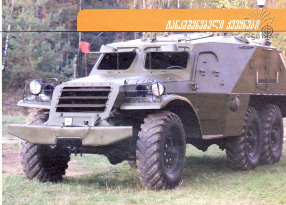
БТР-152: მასა — 8,95 ტ, ეკიპაჟი — 2 კაცი, დენსატი — 17 კაცი, ჯავშანი — 4-13 მმ, კარბიურატორიანი ძრავა — 110ცხ.ძალიანი, სიჩქარე — 65-70 კმ/სთ-ში, სვლის მარაგი — 430 კმ, შეიარაღება — 7,62 მმ-იანი ტყვიამფრეკვეი
