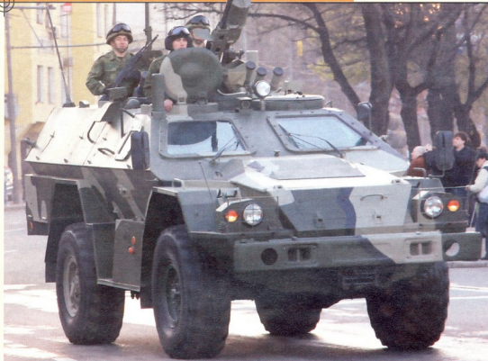
КАМАЗ-43269 Выстрел: მასა — 10,5 ტ, კეპაჟი — 2 კაცი, დესანტი — 8 კაცი, დიზელის ძრავა — 240ცხ.ძალიანი, სიჩქარე — 90 კმ/სთ-ში, სვლის მარაგი — 1100 კმ, შეიარაღება — 14,5 მმ-იანი ან 12,7 მმ-იანი ტყვიამფრქვევი
