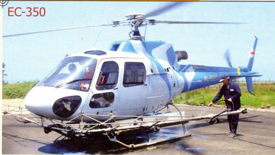
EC-350-ი შესაწამლი აპარატურით აღარამდე და მის შემდეგ (შუა სურათი)
