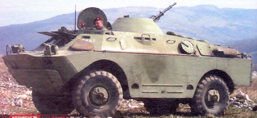
БРДМ-2: მასა — 7,0 ტ, გეიპაუი — 4 კაცი, ჯავშანი — 2-14 მმ, კარბიურატორიანი ძრავა — 140 ცხ.ძალიანი, სიჩქარე — 95-100 კმ/სთ-ში, სვლის მარაგი — 750 კმ, შეიარაღება — 14,5 მმ-იანი და 7,62 მმ-იანი ტყვიამფრქვევები
