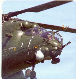
მარჯვენა ქვედა მხარეს დაყენებული ოპტიკურ-ელექტრონული მოწყობილობა, ხოლო ტყვიამფრეველი 23 მმ.-იანი ორულაიანი ქვემოთაა შეკვლილი
