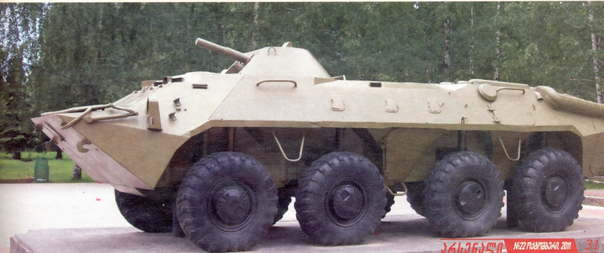
БТР-70: მასა — 12,0 ტ, ეკიპაჟი — 3 კაცი, დენსატი — 7 კაცი, ჯავშანი — 6-10 მმ, კარბიურატორიანი ორი ძრავა — თითოეული 120ცხ.ძალიანი, სიჩქარე — 80 კმ/სთ-ში, სვლის მარაგი — 400-600 კმ, შეიარაღება — 14,5 მმ-იანი და 7,62 მმ-იანი ტყვიამფრეკვეიები
