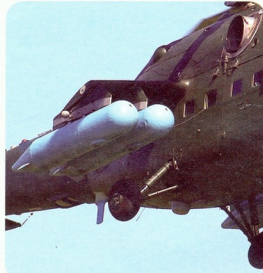
ფრთებზე ჩამოჭრილია თითო-თითო პილონი, ხოლო შასი აღარ იკვებება
