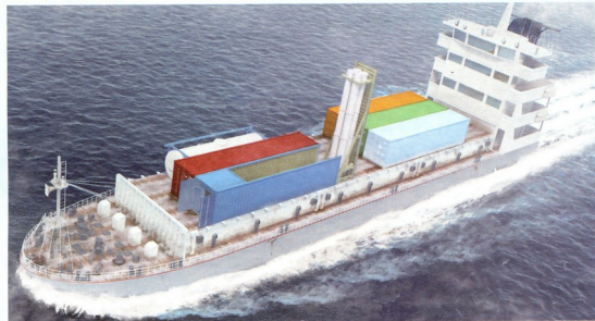
კონტინერებში გემზე CLUB-K ტიპის ზომიდანისა და მდგომარეობის რაკეტების რამდენიმე კონტინერის განთავსება შეიძლება, რის შემდეგ ჩვეულებრივ სამოქალაქო გემი მრისხანე სამხედრო ზომიდანად გადაიქცევა
