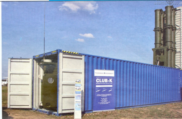
კონტინერებში გემზე CLUB-K ტიპის ზომიდანისა და მდგომარეობის რაკეტების რამდენიმე კონტინერის განთავსება შეიძლება, რის შემდეგ ჩვეულებრივ სამოქალაქო გემი მრისხანე სამხედრო ზომიდანად გადაიქცევა
