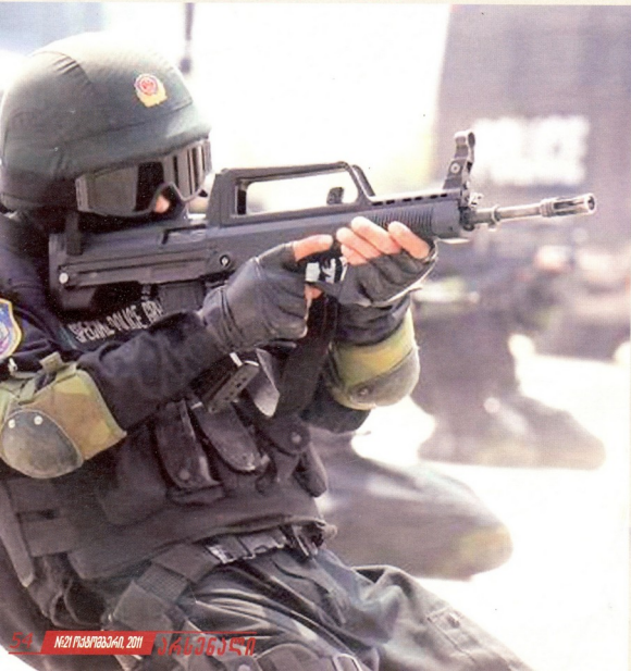
5,8 მმ კალიბრის ჩინური ტყვიამფრქვევი QBZ-95-ი 3,9 კგ-ს იწონის მჭიდის გარეშე და მისი სიგრძე 840 მმ-ია
