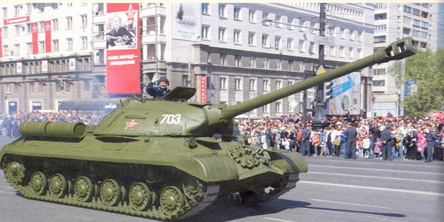
IS-3: მასა – 46,5 ტ, ვიკიპაი – 4 კაცი, ჯგუშანი – 20-120 მმ, დიზელის ძრავა 520ცხ.ძალის, სიჩქარე – 40 კმ/სთ-ში, სელის მარაგი – 185 კმ, შეიარაღება – 125 მმ-იანი ქვემეხი, 12,7 მმ-იანი და 7,62 მმ-იანი ტყვიამურქვევები
