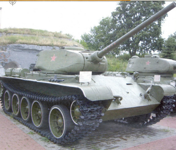
T-44: მასა – 31 ტ, ვიკიპაი – 4 კაცი, ჯგუშანი – 15-120 მმ, დიზელის ძრავა 500ცხ.ძალის, სიჩქარე – 25-60 კმ/სთ-ში, სელის მარაგი – 180-250 კმ, შეიარაღება – 85 მმ-იანი ქვემეხი და ორი 7,62 მმ-იანი ტყვიამურქვევი
