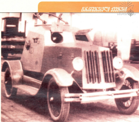
BA-6J-დ: მასა — 5,9 ტ, ეკიპაჟი — 4 კაცი, ჯეჟმანი — 3-8 მმ-იანი, კარბურატორიანი ძრავა 40ცხ.ძალიანი, სინქარე შოსეზე/ვლიანდაგებზე — 43/55 კმ/სთ-ში, სვლის მარაგი შოსეზე — 110 კმ, შეიარაღება — 45 მმ-იანი ქვემუხი და ორი 7,62 მმ-იანი ტყვამფრეკვი
