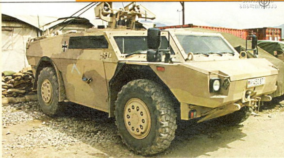
Fennek: მასა — 9,7-10,4 ტონა, ეკიპაჟი — 3 კაცი, ძრავა — 239ც.ხალიანი დიზელი, სიჩქარე — 115 კმ/სთ-ში, სულის მარაგი — 460-1000 კმ, შეიარაღება — 40 მმ-იანი ვუმპარტგოცონი ან 7,62 მმ-იანი ტყვიამფრქვევი
