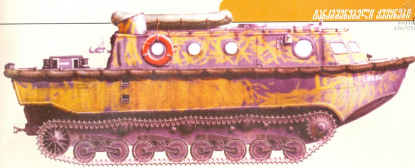
LWS: მასა — 17 ტონა, კარბურატორიანი 650-ცხ.ძალიანი ძრავა, სიჩქარე — წყალში 12 კმ/სთ-ში და ხმელეთზე 32 კმ/სთ-ში, იტყვდა 20 მედეანტეს
