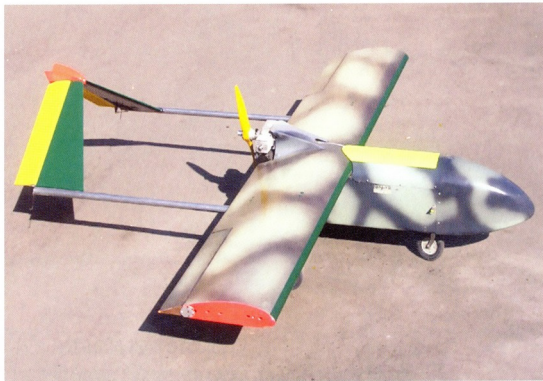
P-600: ფრენის ხანგრძლივობა — 5 სთ, სასარგებლო დატვირთვა — 3-10 კგ, სიჩქარე — 70-200 კმ/სთ-ში, მაქსიმალური სასარგებლო დატვირთვა — 50 კგ, ფრენის მაქსიმალური სიმაღლე — 3000 მ, ფრენის ხანგრძლივობა — 10 სთ
