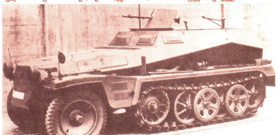
Sd.Kfz.250/1: მასა — 5,38 ტ, ეკიპაჟი — 2 კაცი, დენსატი — 4 კაცი, ჯავშანი — 8-15 მმ, კარბურატორიანი 100 ცხ.ძ.ძალიანი ძრავა, სიჩქარე — 60 კმ/სთ-ში, ხელის მარაგი — 300 კმ, შეიარაღება — 7,92 მმ-იანი ტყვიამფრეკვე
