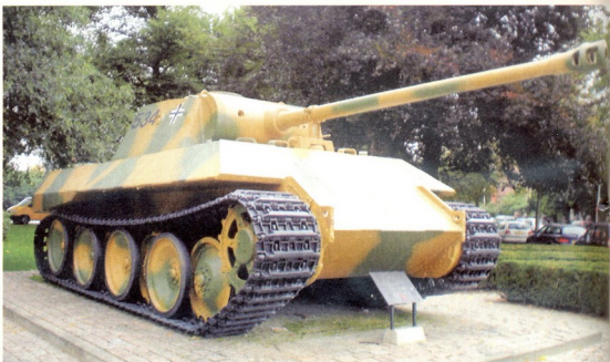
Pz Kpfw V Panther Ausf D: მასა – 43 ტ, ჯავახანი – 16-100 მმ, ეკიპაჟი – 5 კაცი, კარბურატორიანი 700 ცხ. ძალიანი ძრავა, სიჩქარე – 46 კმ/სთ-ში, ხელის მარაგი – 200 კმ, შეიარაღება – 75 მმ-იანი ქვეშეხი და 7,92 მმ-იანი 2 ტყვიამფრექვეი
