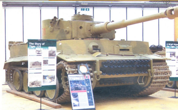
Pz Kpfw VI Tiger Ausf E: მასა — 56,9 ტ, ჯეშანი — 28-100 მმ, კვიპაი — 5 კაცი, კარბურატორიანი 650 ცხ. ძალიანი ძრავა, სიქარე — 20-38 კმ/სთ-ში, სელის მარაგი — 60-100 კმ, შუიარალება — 88 მმ-იანი ქვეშითი და 7,92 მმ-იანი 2-3 ტყვიამფრევევი
