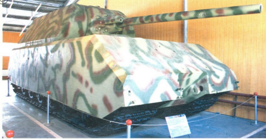
Maus: მასა - 188 ტ, ჯავშანი - 65-200 მმ, ეკიპაჟი - 5 კაცი, კარბურატორიანი 1080 ცხ. ძალიანი ძრავა, სიჩქარე - 20 კმ/თ-ში, სვლის მარაგი - 186 კმ, შეიარაღება - 128 მმ-იანი და 75 მმ-იანი ქვემოები, 7,92 მმ-იანი 1 ტყვიამფრევე
