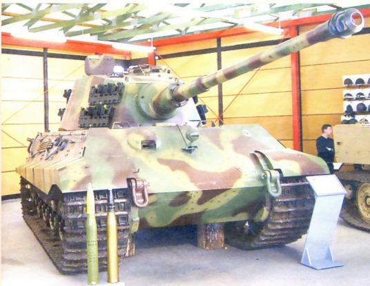
Pz Kpfw VI Tiger II Ausf B: მასა — 69,8 ტ, ჯეშანი — 40-150 მმ, კვიპაი — 5 კაცი, კარბურატორიანი 700 ცხ. ძალიანი ძრავა, სიქარე — 20-38 კმ/სთ-ში, სელის მარაგი — 120-170 კმ, შუიარალება — 88 მმ-იანი ქვეშითი, 7,92 მმ-იანი 2-3 ტყვიამფრევევი და 26 მმ-იანი მორტარა
