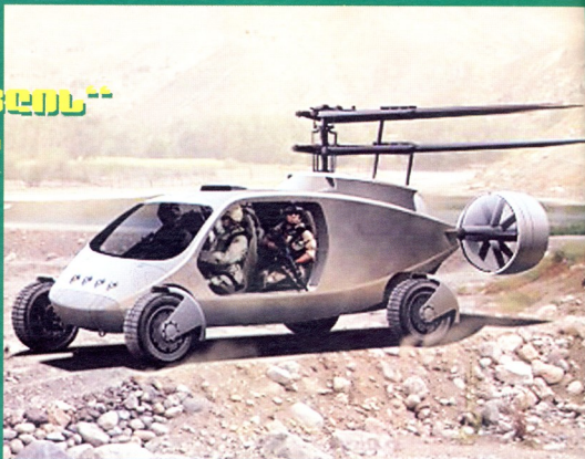
წამი სჭირდება. მთავარი ბრანჩის გარდა ავტომატილს უკანა ნაწილში ორი ვენტორატორია აქვს, რომლებიც პორიზონტალური ფრენის რეჟიმში აჩქარებას განაპირობებენ. მათი მოძრაობა ქვემოთკენაც შეიძლება, რათა აფრენის დროს დაბატებითი ამწევი ძალა გამოიმუშაოს.
