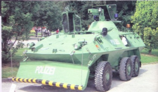
„პირანის“ შასიზე დამზადებული სამოლიციო ჯავშანტრანსპორტიორი
