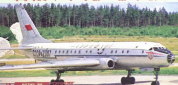
თვითმფრინავზე რეკერსის ორარსებობის გამო, დაეგომოსას მანძილის შესამცირებლად Ty-104-ზე სამუხრუტე პარიმუტები გამოყენებოდა
