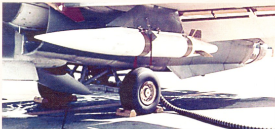
რაკეტა SRAM-90 B-52-ის მრავალბოზიციურ დოლური ტიპის გამშვებ დანადგარზე (ზედა ფოტო) და FB-111-ის ფროთაქვეშა ბოლოზე (ქვედა ფოტო)
