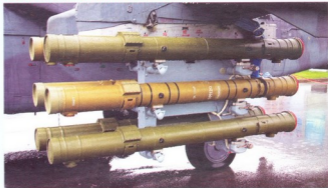
კომპლექს ATAKA-ს ტანდემური კომულაციური საბრძოლო ქობინით და რაკეტების, Ka-52-ისა და Ми-28მ-ის ტიპის შეუქმნაფრთხელზე განთავსების სქემა
