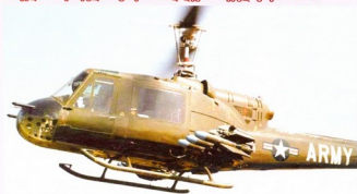
ფრანგული რაკეტის ბაზაზე შექმნილი ამერიკული ტრანსინიალმდგომი მართავი რაკეტა AGM-22 და მისით შეიარაღებული პირველი ამერიკული ტრანსინიალმდგომი შეველმფრენი UH-1D
