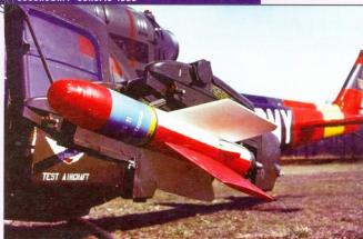
ფრანგული რაკეტის ბაზაზე შექმნილი ამერიკული ტრანსინიალმდგომი მართავი რაკეტა AGM-22 და მისით შეიარაღებული პირველი ამერიკული ტრანსინიალმდგომი შეველმფრენი UH-1D
