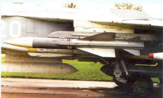
რადიოლოკაციურსაწინააღმდეგო რაკეტა X-58 და საფრონტო ზომბამშენ Cy-24-დან მიღი დამზნების კონტინტერი ფანტასმაგორია
