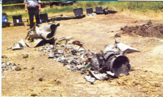
2007 წლის 6 აგვისტოს, სოფელ ნიოთელბანიან ჩამოგდებული რუსული X-58Y-ის ფრაგმენტები
