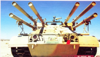
მძიმე უსაუზარებო ქვემეხით აღტურვილი თეთომავალი საარტილერიო დანიდგარო M50 Ontos-ი ვიეტკონგებებს გამანადგურებელ ცეცხლს უხსნიდა
