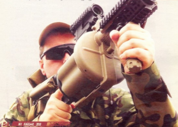
ყუმბარსატფორცის დოღურა რეკოლვერის დოღურასავით მარცხნივ იხსნება და მსროლელი მასში 40 მმ-იან ყუმბარებს აწყობს
