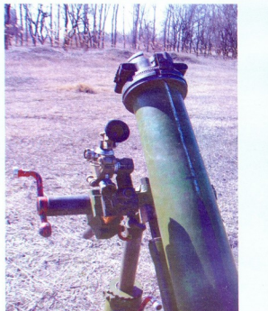
თუკი ნაღმი არ გაეარდა, ნაღმსატყორცნის ლულის აყირავებენ და ნაღმს ფრთხილად იღებენ
