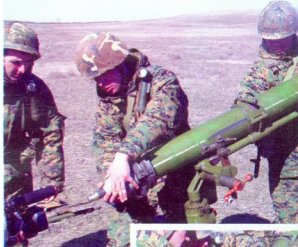
თუკი ნაღმი არ გაეარდა, ნაღმსატყორცნის ლულის აყირავებენ და ნაღმს ფრთხილად იღებენ
