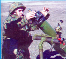
ნაღმსატყორცნის ლულის თავში დამონტაჟებული დამცველი გამორიცხავს ორი ნაღმის ლულაში ჩაშვებას
