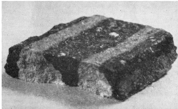
ნახ. 34. წლის ექსპლუატაციის შემდეგ საფარიდან ამოკვეთილი ნახევრადხისტი საფარის ნიმუშის საერთო ხედი, რომელიც მოიცავს ქვიშა-ცემენტის ხსნარის ღეროებს
