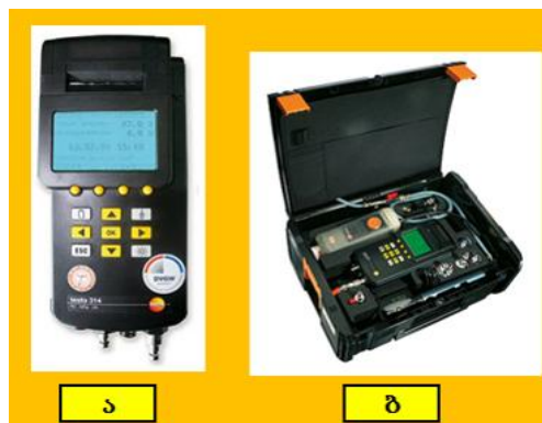
ნახ. 40. წნევის გამზომი ხელსაწყო testo 314-ს ხედი: ა. ხელსაწყო testo 314; ბ. ელექტრონული კეისი
