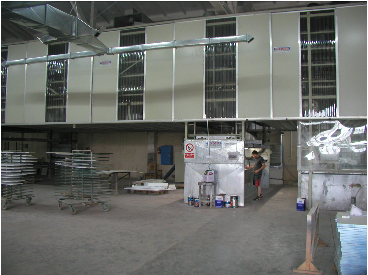
კომპანია „არისის“ (დამფუძნებელი სს „ორბელი-91“) მექანიზირებული გასალაქი ხაზი, დეტალების საშრობში ავტომატური მიწოდებით.
