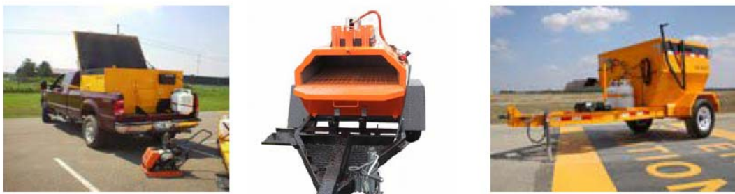
ნახ. 28 მობილური „hot box“ ასფალტბეტონის რეგენერატორი
