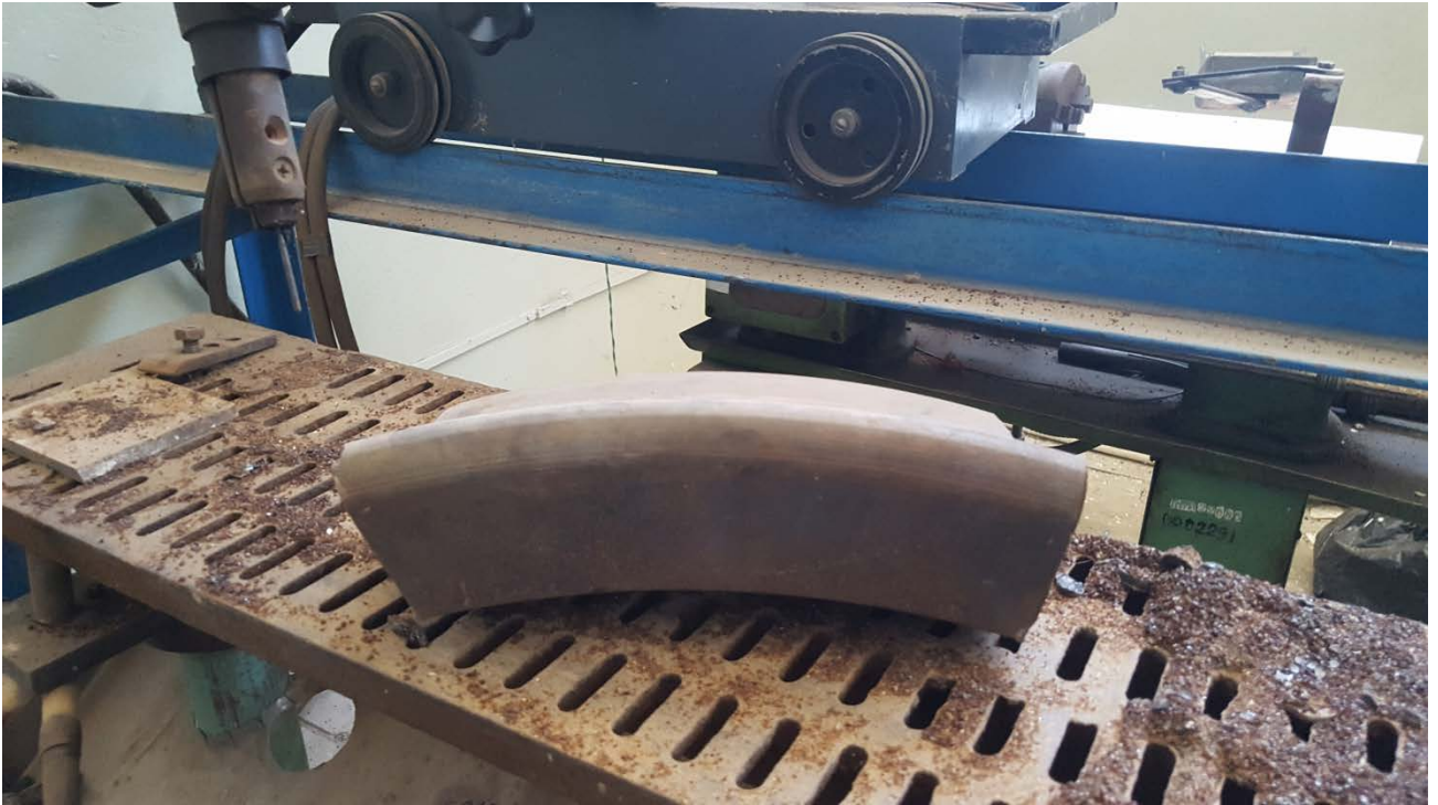
სურ. 4.2 გოგორათვალისანი ამოჭრილი ნიმუშის ფრაგმენტი შემდგომი მექანიკური დამუშავებისა და შედუღებისათვის
