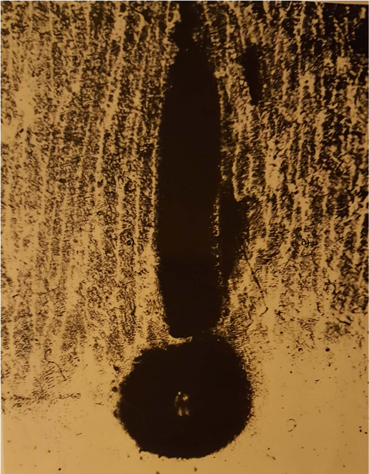
სურ. 4.8 წიდური ჩანართები და კრისტალიზაციური ბზარი მრავალგავლიანი შედუღების ბოლო ფენაში
