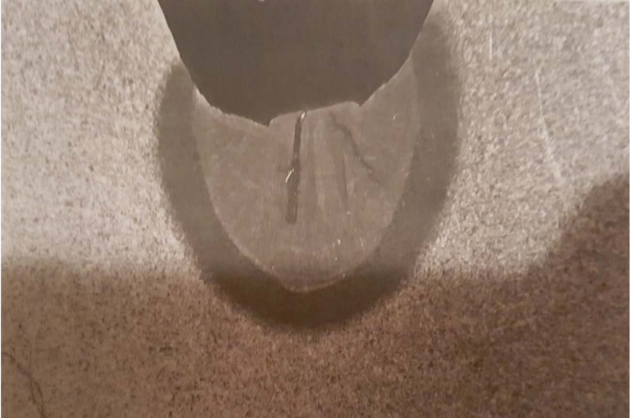
სურ. 4.6 კრისტალიზაციური ბზარები სერიული მავთულით CB-08xΓ2CMΦ შედულებული მრავალგავლიანი შედულების პირველ ფენაში
