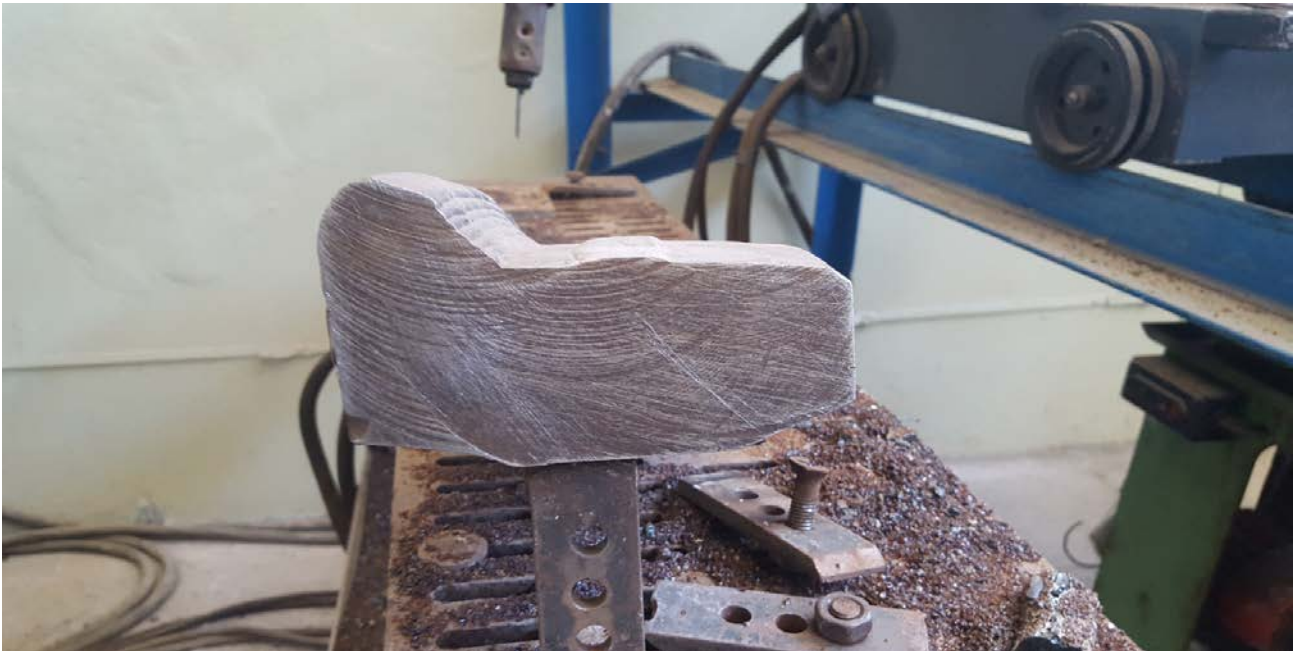
სურ. 4.3 მრავალგავლიანი შენადული ნაკერის ნიმუში და ამონაჭერი ჩამაგრებული სპეციალური დამჭერებით
