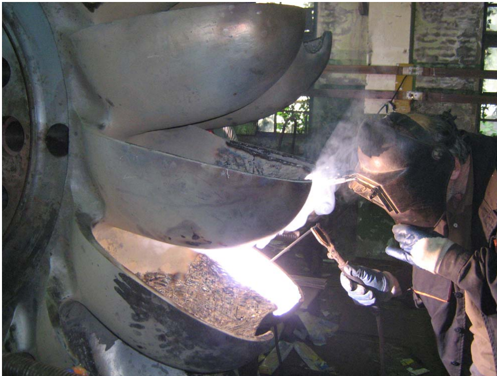
სურათი 4. მუშა თვალის ჩამქის დაზიანებული ზედაპირის დადუღების პროცესი
