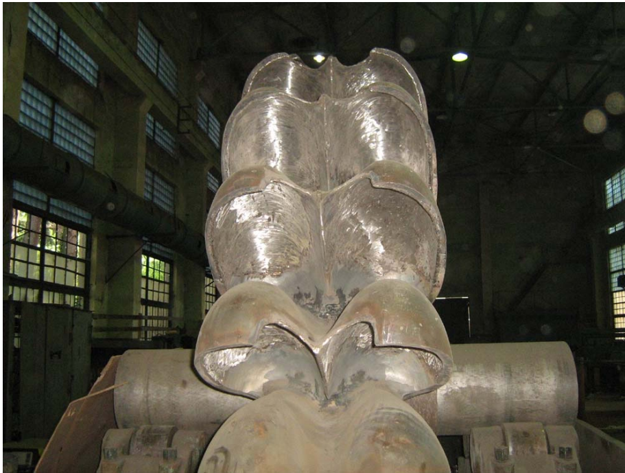
სურათი 2. მუშა თვლის ბაზირება გორგოლაჭიან სამარჯვზე
