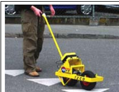
სურათი №5 – ჩაჭიდების კოეფიციენტის განსაზღვრის ხელის საგორავი მოწყობილობა.
