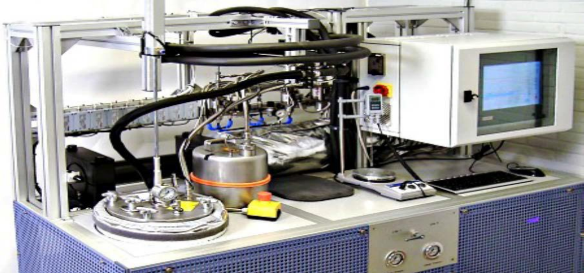
სურ.4. ანტიტურბულენტული მისართების ლაბორატორიული გამოცდის სტენდის საერთო ხედი
