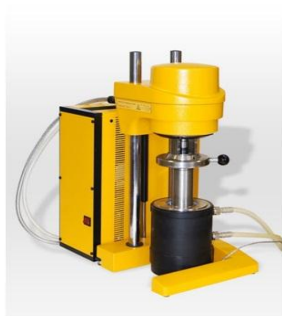
სურ. 8. როტაციული ვისკოზიმეტრი RHEOTEST RN დინამიკური სიბლანტის განსაზღვრისათვის 0,5- 107 მპა. წმ ; T=10 - 150 °C-ის დროს
