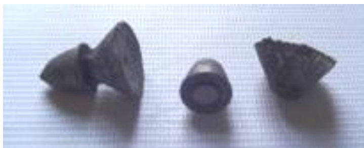
სურ. 11. მარცხნივ მოცემულია სხმული ნახევარფაბრიკატი, ხოლო მარჯვნივ – დინამიკურად გაყოფილი ორი ტიპის ნაკეთობა
