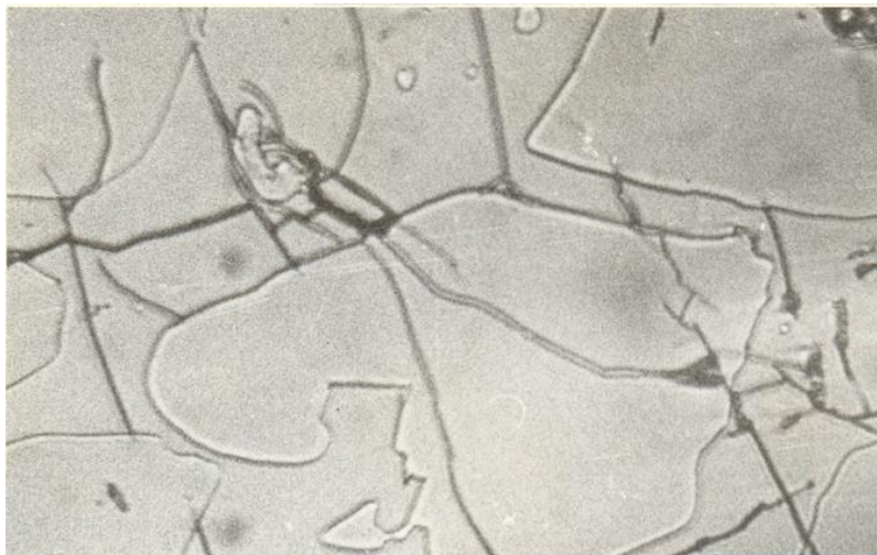
სურ. 4. CrO 3 : B 2 O 3 : Al : 0,36 : 0,25 : 0,39 ნარევიდან მიღებული ქრომის ბორიდის მიკროსტრუქტურა; ფაზური შედგენილობა CrB 2 ; შეიმჩნევა Cr x Al y B z კვალი; მიკროსისალე 2100–2300 კგ/მმ 2
