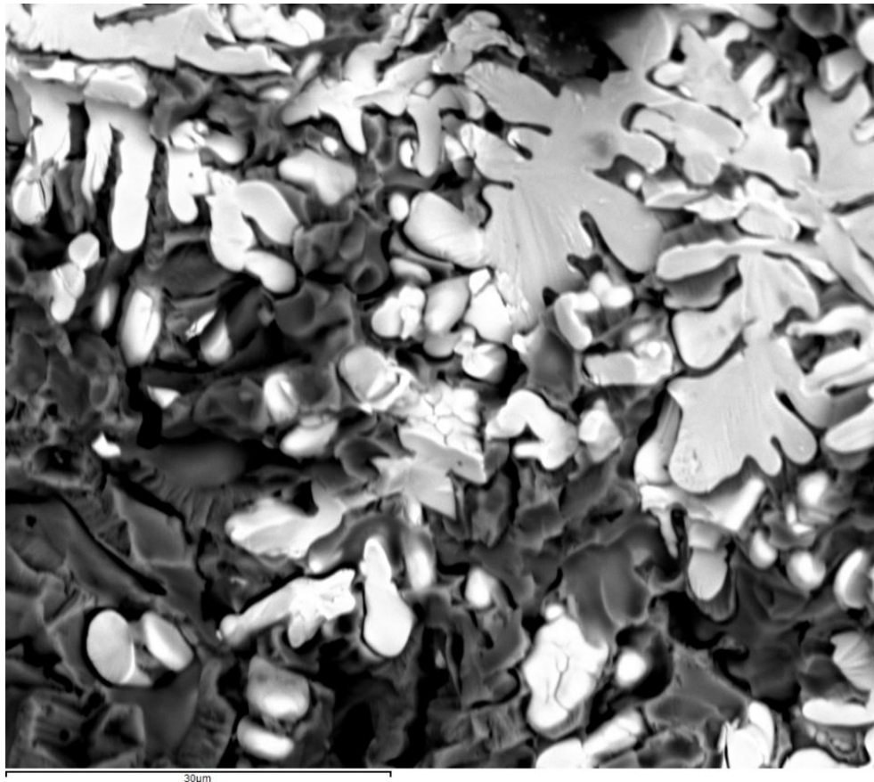
სურ. 6. № 3 შედგენილობის (ცხრ., №1) მასალის დენდრიტული სტრუქტურა, კომპონენტების ფარდობა x70\% + y30\%
