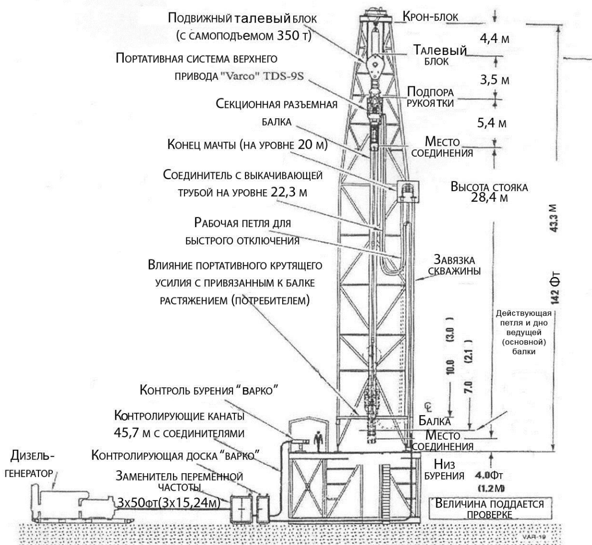
Рис. 1. Буровая система TDS «топ-драйва», работающая в режиме верхнего привода
