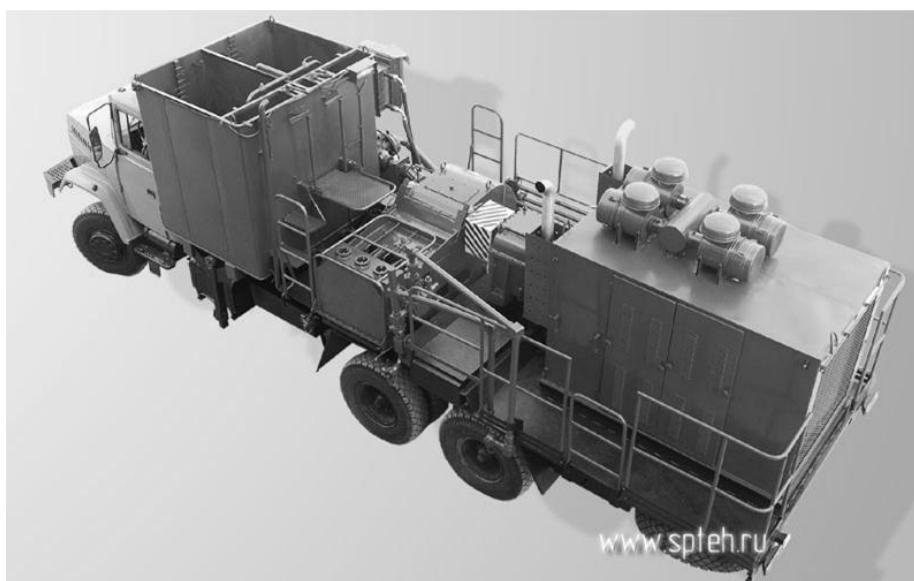
Рис.5. Цементировочный агрегат марки ЦА – 700 (Россия).
