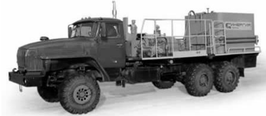
ნახ. 4. სპეცტექნიკის (რუსეთის) СИН35.02 მარკის დასაცემენტებელი აგრეგატი
