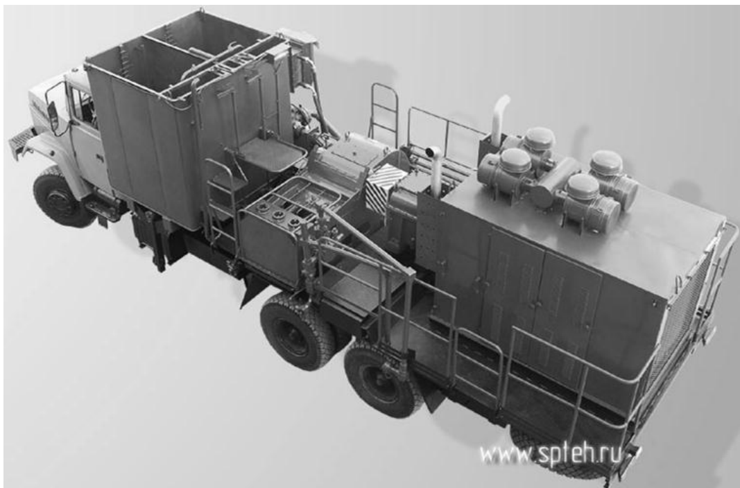
ნახ. 5. სპეცტექნიკის (რუსეთი) ЦА – 700 მარკის დასაცემენტებელი აგრეგატი
