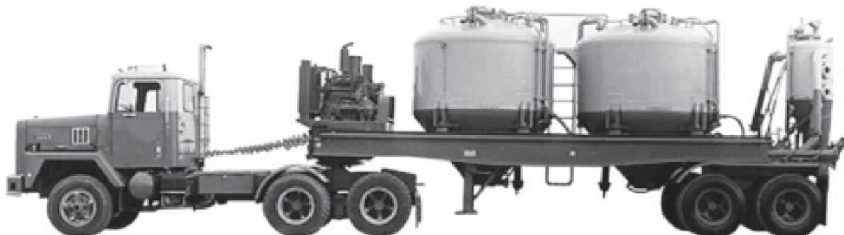
Рис. 2. Цементировочная установка типа HT – 660 компании Холлибертон.
