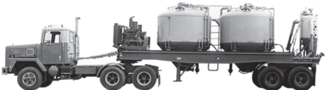
ნახ. 2. ჰოლიბერტონის კომპანიის HT - 660 ტიპის დასაცემენტებელი დანადგარი
