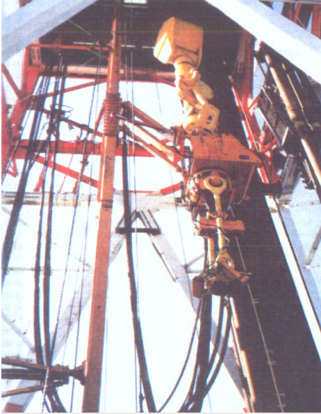
მცირეგაბარიტიანი მაღლივი ამძრავი კომპანია Tesko აღჭურვილია გადახრული მოწყობილობით, რომელიც საშუალებას იძლევა, რომ გადავხაროთ იგი შურფის მიმართულებით
