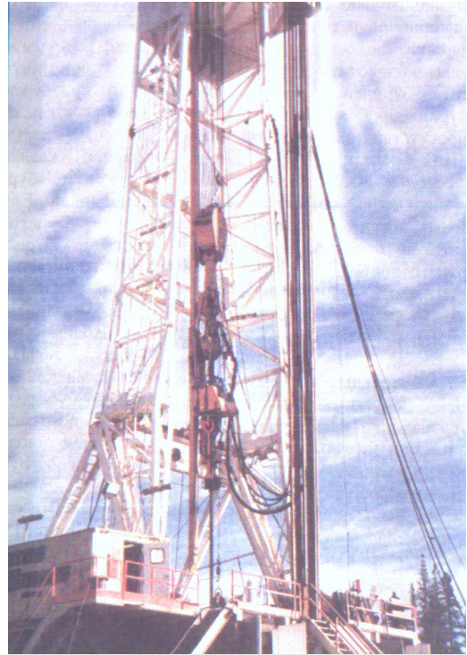
მცირე ზომებისა და მასის მქონე მცირეგაბარიტიანი მაღლივი ამძრავი საშუალებას იძლევა შევამციროთ საწვავის ხარჯი და ტალღური ბაგირის საექსპლუატაციო ხარჯები
