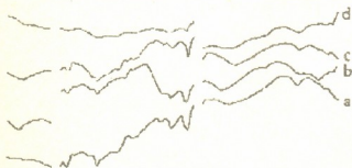
სურ. 1. სინთეზირებულ ნაერთთა იწ სპექტრები: Ag 3 AsS 4 (ა); Zn 3 (AsS 4 ) 2 ·4H 2 O (ბ); Cd 3 (AsS 4 ) 2 ·2H 2 O (გ); Hg 3 (AsS 4 ) 2 ·2H 2 O (დ)
