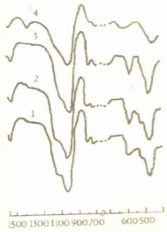
სურ.2. Cu, Ni, Cr-შემცველი ფოფაზიტების DTA-ს სპექტრი 1 - NaY(ეტალონური), 2 - NaNiY, 3 - NaCuY, 4 - NaCrY
