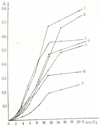
Рис. 3. Зависимость оптической плотности растворов (600 нм) восстановленных комплексов Mo(VI) с фосфорсодержащими лигандами от соотношения Mo(VI) : лиганд: 1— PO_4^{3-} , 2—ОБДФ, 3—ОЭДФ, 4— P_2O_7^{4-} , 5— P_3O_{10}^{5-} , 6—ГТФ, 7—ЭДТМФ. C_{фл}=1 \cdot 10^{-4} М, C_{аск}=0,03 М, C_{Ca}=4 \cdot 10^{-5} М, рН 3,5, время реакции 30 мин, l=2 см
