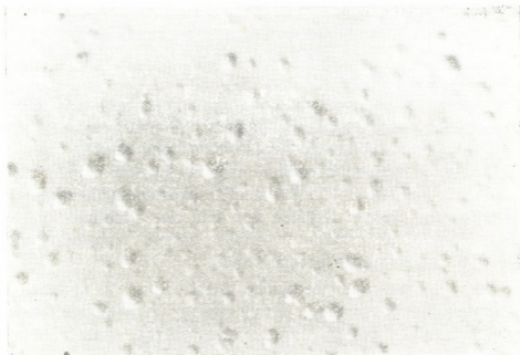
Рис. 1. Электронно-микроскопический снимок стекла состава 29\text{Li}_2\text{O} \cdot 71\text{SiO}_2 (по синтезу) ( \times 10\,000 )
