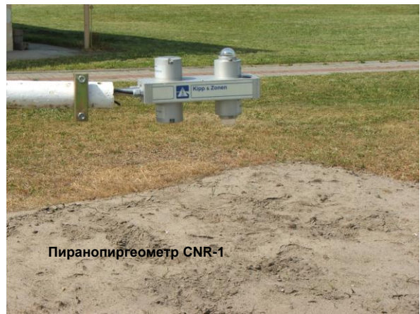
Фото 1. Датчики пиранопиргеометра CNR-1, наблюдающие остаточную солнечную радиацию Q^* поверхности травы и почвы без растений с августа 2007 по апрель 2014 года во Вроцлаве-Свойце
