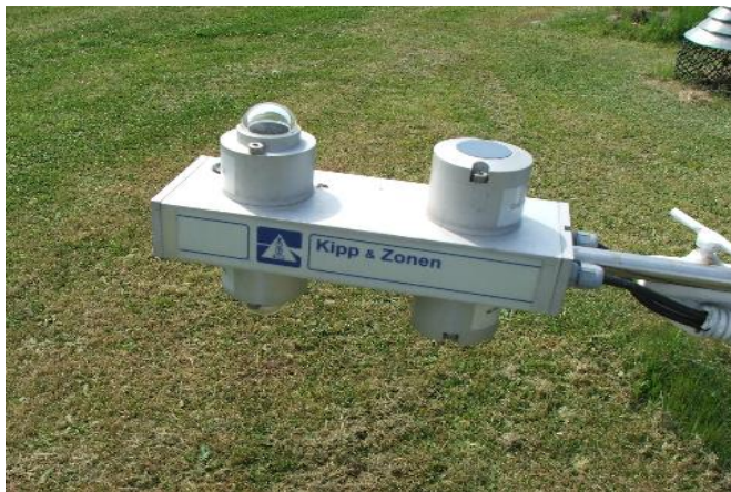
Фото 1. Датчики пиранопиргеометра CNR-1, наблюдающие остаточную солнечную радиацию Q^* поверхности травы и почвы без растений с августа 2007 по апрель 2014 года во Вроцлаве-Свойце
