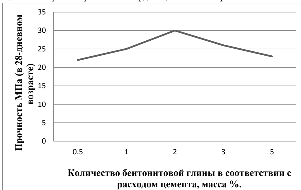
Рис. 1 Изменение прочности бетона в зависимости от количества бентонитовой глины
