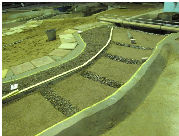
Рис. 6. Система поперечных дамб из крупного камня, заглубленных в дно и искусственных порогов для стабилизации вертикального врезания русла на канализированных участках
