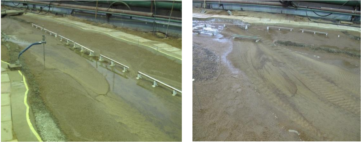
Рис.3. - Мезоформы в русле реки при расходах воды в диапазоне 100–740 м 3 /с
