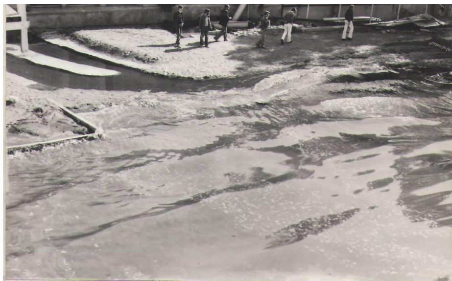
ნახ. 6. ლაბორატორიული კვლევები ენერგეტიკის ს.კ. ინსტიტუტის დიდ ტალღათწარმომქმნელ აუზში [3], (1984-1985წწ)
