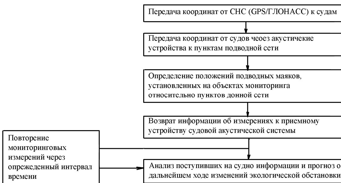
Рис.2. Технологическая схема мониторинга морских подводных объектов
