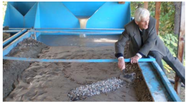
Рис. 4. Устройство прямолинейной модели устроенной под углом 40^\circ к динамической оси потока
