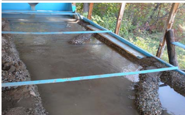
Рис. 6. Модели струенаправляющих шпор с поочередным размещением (рекомендованный вариант)
