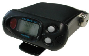
ნახ.6. რადიაციული უსაფრთხოების პორტატიული აპარატურა
