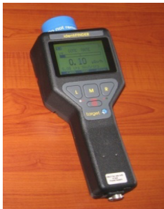
ნახ.6. რადიაციული უსაფრთხოების პორტატიული აპარატურა
