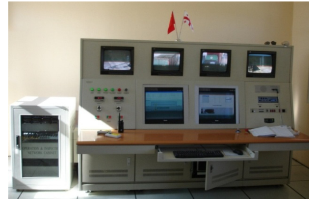
ნახ.2. სტაციონარული რენტგენ-სკანერი THSCAN MB1215HS (ა) და რენტგენ-სკანერის მართვის პულტი (ბ)
