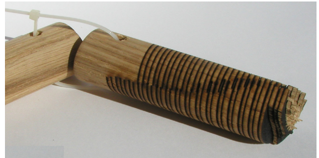
სურათი 4 ექსპერიმენტალური საექსტრაციო სპირალი, რომელიც 75 ვატის სიმძლავრის ლაზერთაა დამუშავებული.
