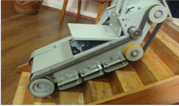
სპეციალური საჭიროების მქონე პირების გადასადგილებელი კიბეზემავალი სატრანსპორტო საშუალების მასშტაბური მოდელი
