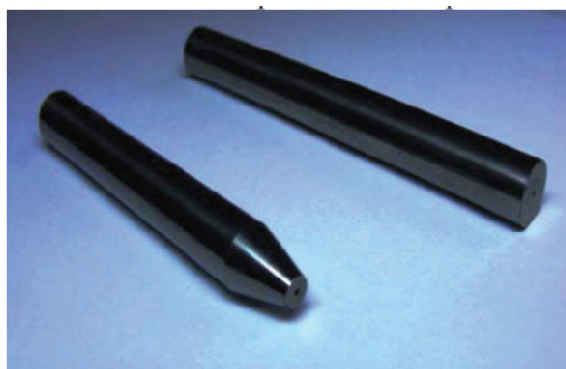
Рисунок 18. Сопло Вентури для водоструйной резки из \text{TiC-Ni} (10 мас. %).
