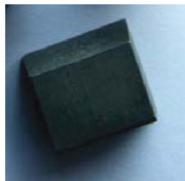
Рисунок 19. Резец твердых материалов, изготовленный из \text{WC-Co} (10 мас. %).
