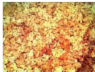
Рисунок 15. Микроструктура ( \times 400 ) поверхности композиционных образцов латуни + 1 вес. % h-BN, полированных механически (а) и химически (б),
